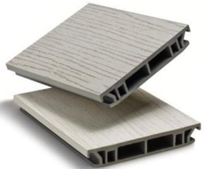
La surface de la lame Optima Plus est une peau en PVC coextrudée et poncée. Le PVC rend la lame imperméable, et la finition poncée permet la bonne adhérence du platelage. En contrepartie, le ponçage peut provoquer une fine rétention d'eau localisée sur certains secteurs du platelage.
